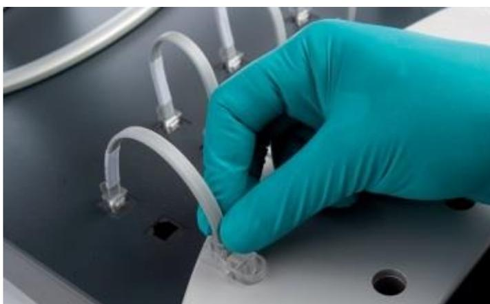
**Figura J.10.** Posición final del cable del sensor tras su conexión.
