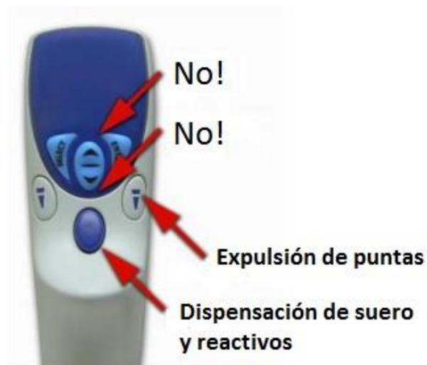
Figura J.11. Botones de la pipeta electrónica.
