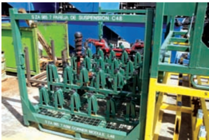
La compañía oscense provee los contenedores para el conjunto subframe de la dirección del vehículo y de parejas de suspensión del nuevo Corsa. The company from Huesca supplies the containers for the vehicle's steering subframe assembly and for the suspension pairs of the new Corsa.
