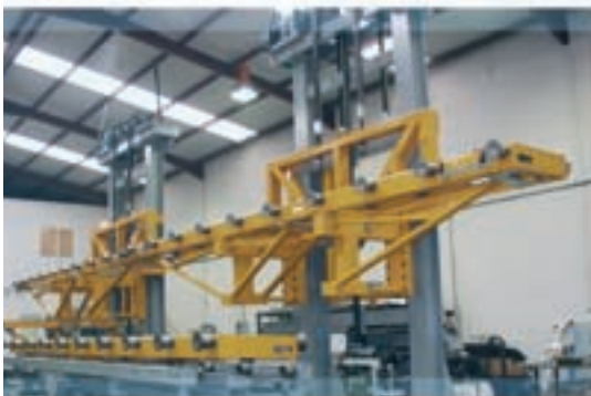
● Mantenimiento. Elevador transferidor de grandes cargas.
