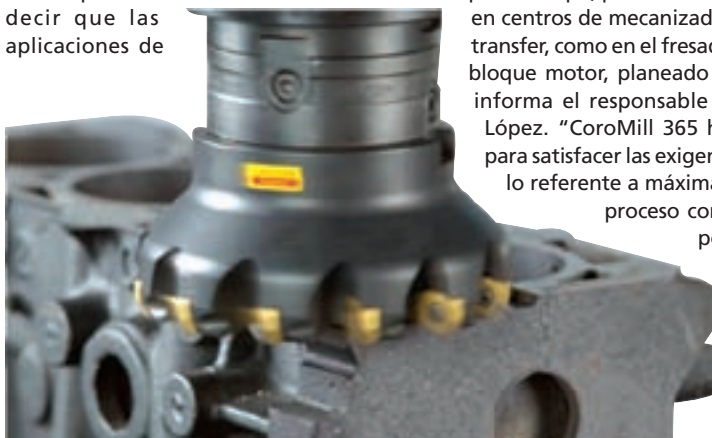
Entre los últimos desarrollos de Sandvik Coromant destaca la nueva fresa CoroMill 365 para el mecanizado económico de fundición.
