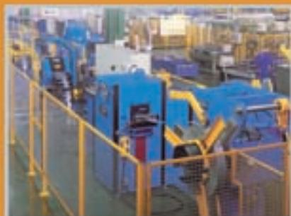
Perfilado y soldadura
